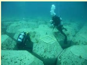
島根県にある原子力発電所で、消波施設の人エリーフに海藻が入植していく様子を潜水調査で追跡しています。
