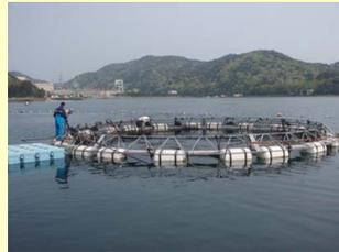
若狭湾にある原子力発電所で、試験場の協力を得て、生簀を使って大型魚類の温排水行動反応試験を行っています。
