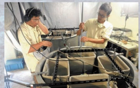
試験水槽内の低周波水中音の計測
