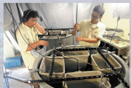
試験水槽内の低周波水中音の計測
