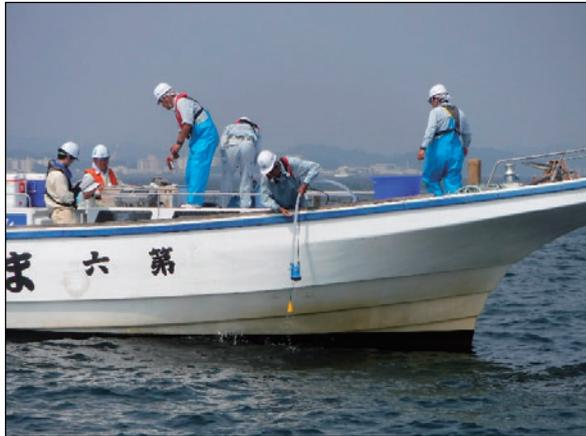
第5図 投げ込み式水中ポンプによる小型船での採水
