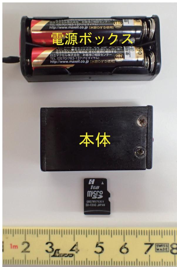
第3図 魚類用脳波測定データロガーの全体像
