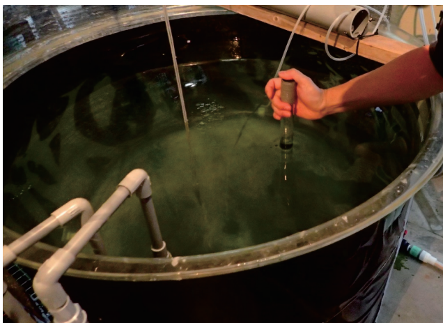
第8図 柱状サンプリングの作業風景
