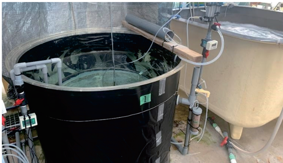
第7図 種苗生産水槽の外観と装備（第6図参照）
