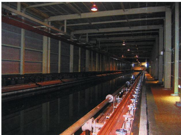
図1 長水槽 (漁船推進性能実験棟)
