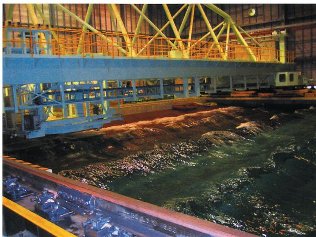
図2 リアルな波 (海洋工学総合実験棟)
