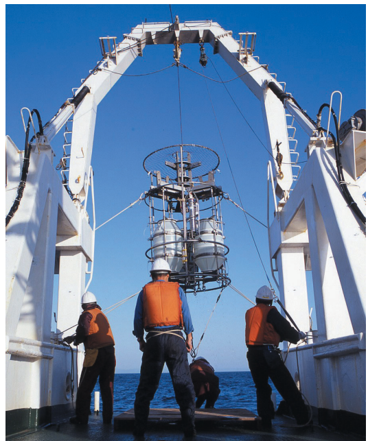
採水器の揚収作業
