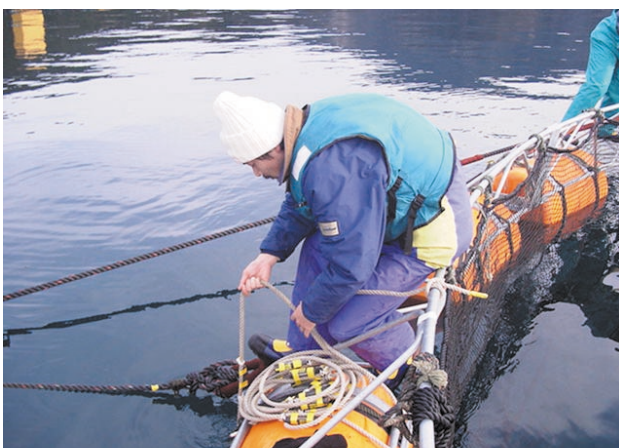
写真5 試験生け簀に設置した水温計 試験生け簀内の水温を連続測定するために、メモリー式水温計13個を設定水深(0.5～8m)に合わせて取り付け、それぞれの生け簀の周囲4点に設置し、毎日データを回収する。
