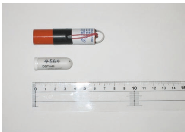
写真3 ブリに装着した測器 上の測機(ピンガー)、又は下の測機(データロガー) の何れかをブリの背面に装着する。
