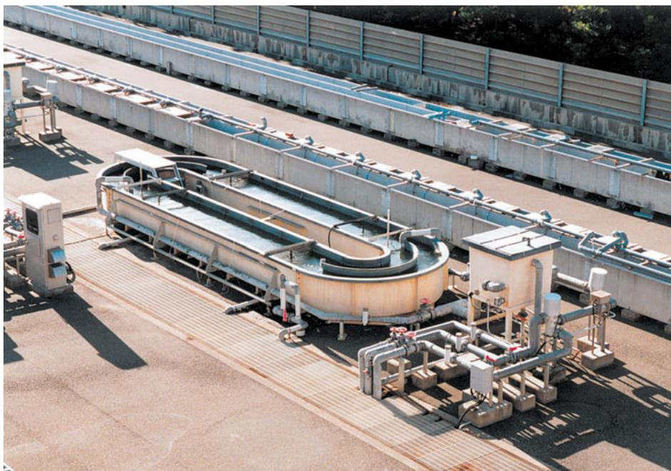
第1図 屋外試験に使用した流水式回流水槽
