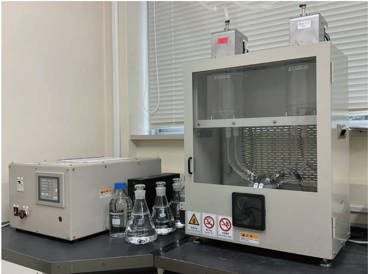
トリチウム電解濃縮装置「トリピュア®」(デノラ・ペルメレック株式会社製)
