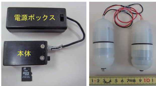
図3 魚類用脳波測定データロガーの全体像(右図は、データロガーを防水ケースに収容した様子)
