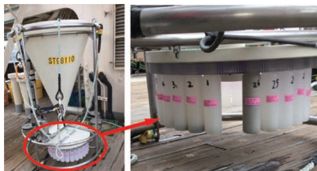
図2 回収後のトラップ(左)と沈降粒子が捕集されたボトル(右)(高知大 池原実教授撮影)
