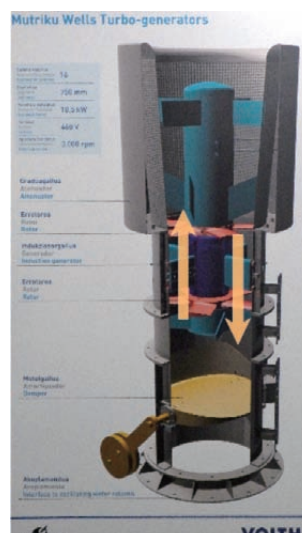
タービン内模式図 (出典: 写真撮影した説明用展示パネルを一部改変し、空気の流れを矢印で示す)
