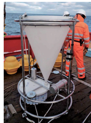
第2図：北極海に投入する前のセディメント・トラップ。三角錐の容器に上から降ってきたマリンスノーを集める。
