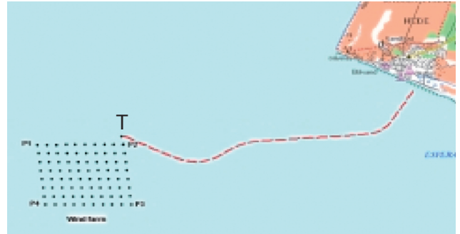
第1図 洋上風力ファームとケーブル位置（T：変電施設）
