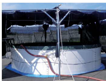
実験水槽は直径5m。中央の柱(直径1.2m)に付ける海藻の量を変えて魚の行動を調べます。
