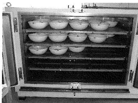
第 2 図 供試料を部位別に分取した磁製皿と乾燥機
