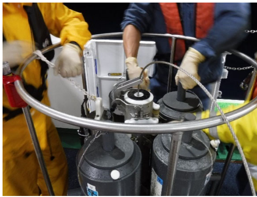
③揚収後にニスキン採水器を確認する様子
