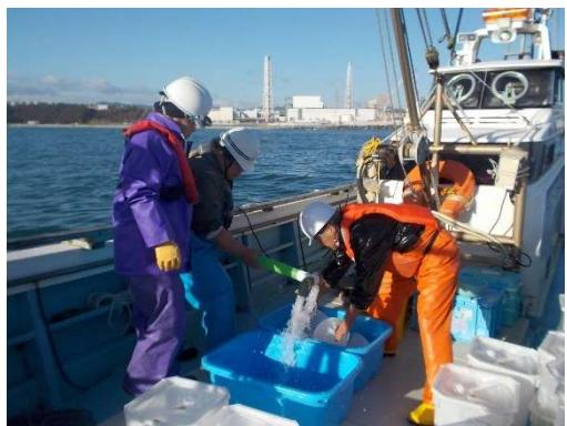
④水中ポンプを用いた海水試料採取作業
