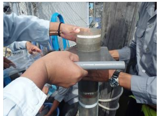
鉛直分布用柱状海底土試料の分取
