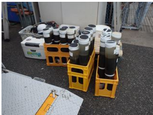
鉛直分布用柱状海底土の固定状況
