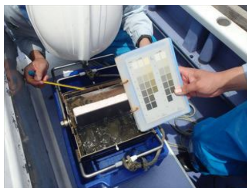
海底土試料の泥色、泥温測定
