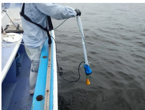
投げ込み式水中ポンプによる表層海水採取
