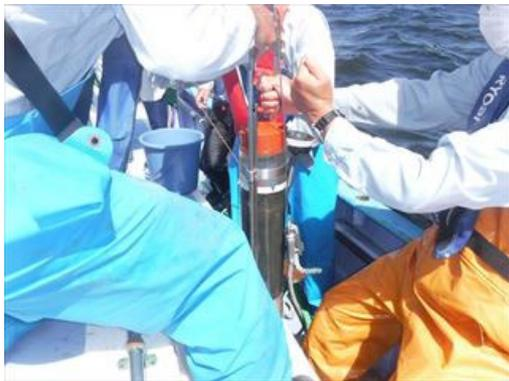
蓄積量用柱状海底土の採取状況
