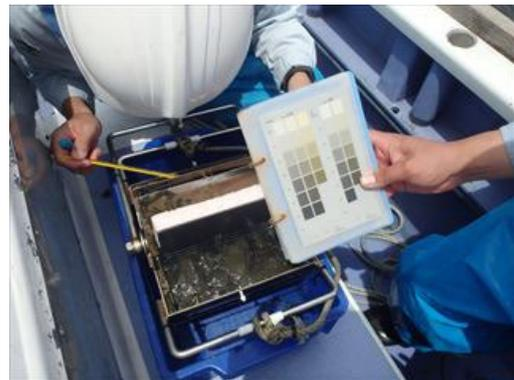
海底土試料の泥色、泥温測定
