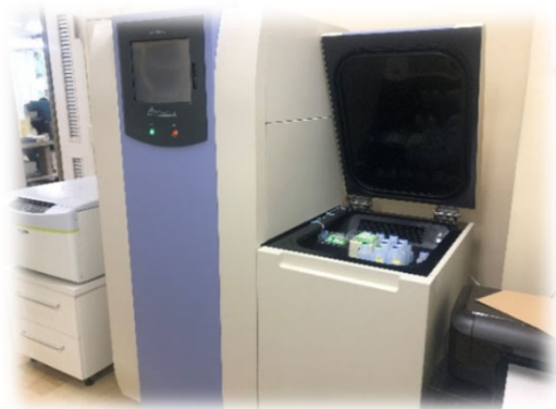
トリチウムから発せられる極めて低いエネルギーのベータ線を測定するための液体シンチレーションカウンタ(一例)
