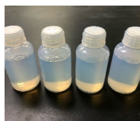
試料水とシンチレータを混合させた測定溶液
