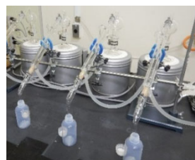
常圧蒸留装置の例 濃縮した試料水を精製します
