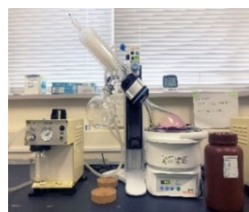
減圧蒸留装置の例 試料水に試薬を加えて精製します
