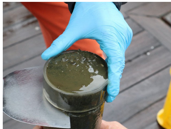
海底土試料の採取作業 (柱状試料として採取した海底土を表層3cmにスライスして分取している様子)
