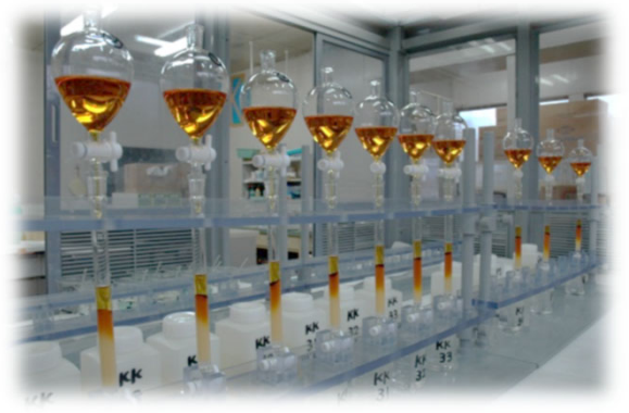
プルトニウム-239+240分析での化学分離・精製に用いる陰イオン交換樹脂カラム(一例)
