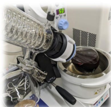
トリチウム分析における減圧蒸留装置(一例)
