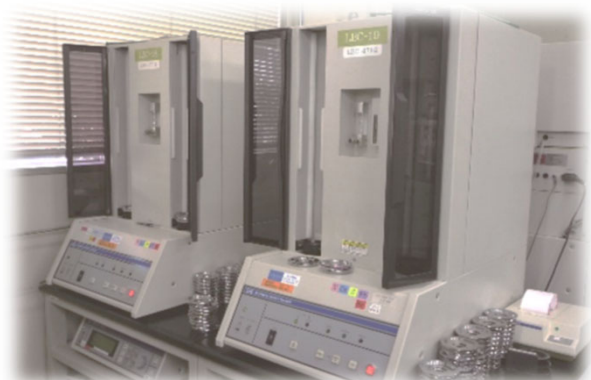
ストロンチウム-90を定量する際に用いる低バックグラウンドガスフローβカウンタ(一例)
