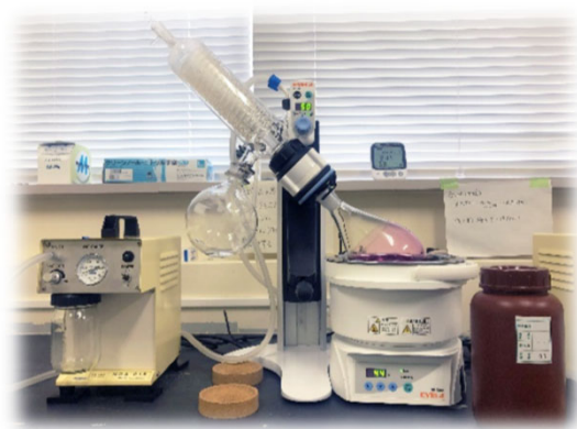
トリチウム分析における電解濃縮前に、減圧蒸留を行うための準備をしているところ
