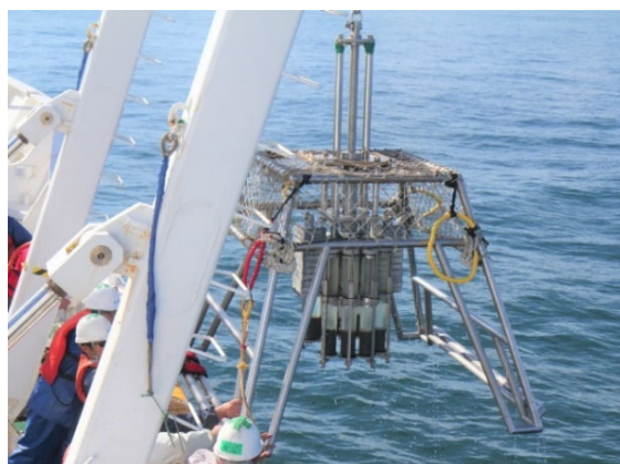
採泥器による採泥作業 （写真は主に柱状海底土を採取するためのマルチプルコアラー）
