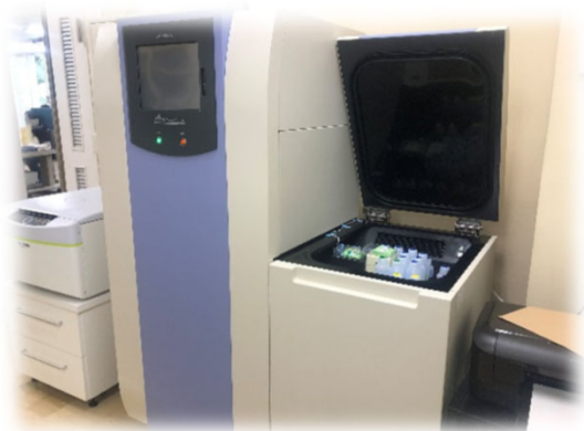
トリチウムから発せられる極めて低いエネルギーのベータ線を測定するための液体シンチレーションカウンタ
