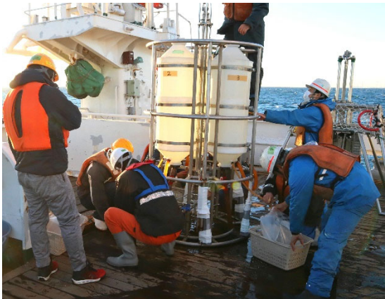
海水試料採取作業 （バンドーン式大型採水器から海水を分取している様子）
