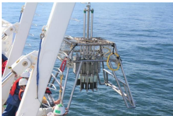
採泥器による採泥作業 （写真は主に柱状海底土を採取するためのマルチプルコアラー）
