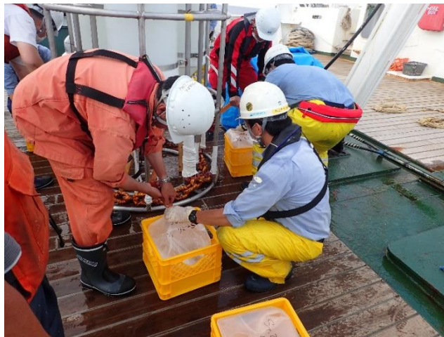
海水試料の採取作業 （大型バンドーン採水器から20リットル容器に分取している様子）
