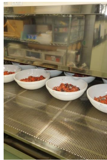
海産生物試料の前処理 (大型乾燥器による乾燥後に 電気炉で灰化)
