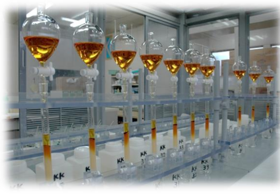
プルトニウム-239+240分析での化学分離・精製に用いる陰イオン交換樹脂カラム(一例)
