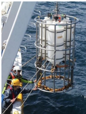
大型バンドーン採水器による採水作業 （写真は容量約120リットル×3連） （令和元年度の作業例）
