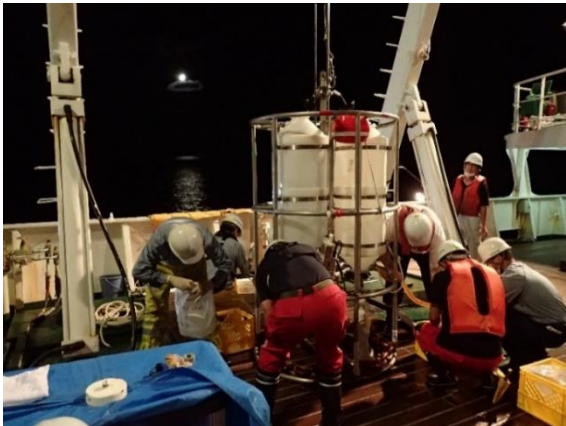
夜間における海水試料採取作業 （バンドーン式大型採水器から20リットル容器に分取している様子）
