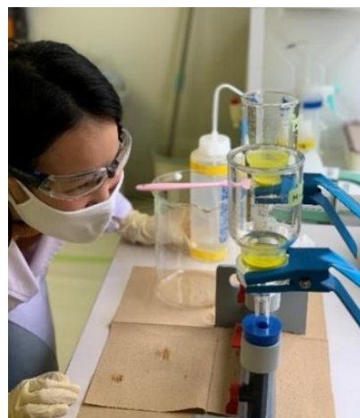
海水試料に含まれる放射性セシウムの放射化学分析の様子（AMPをろ過しているところ）
