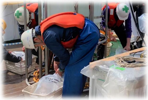
海水試料の採取作業（バンドーン式大型採水器から20リットル容器に分取している様子）（令和元年度の作業例）
