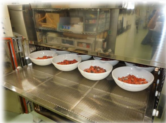
海産生物試料の前処理(大型乾燥器による乾燥後に電気炉で灰化)
