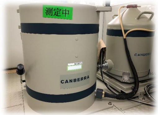
ガンマ線スペクトロメトリーに用いる高純度ゲルマニウム半導体検出器(一例)(「測定中」の部分には鉛の遮蔽で、右は液体窒素デューフ容器)
