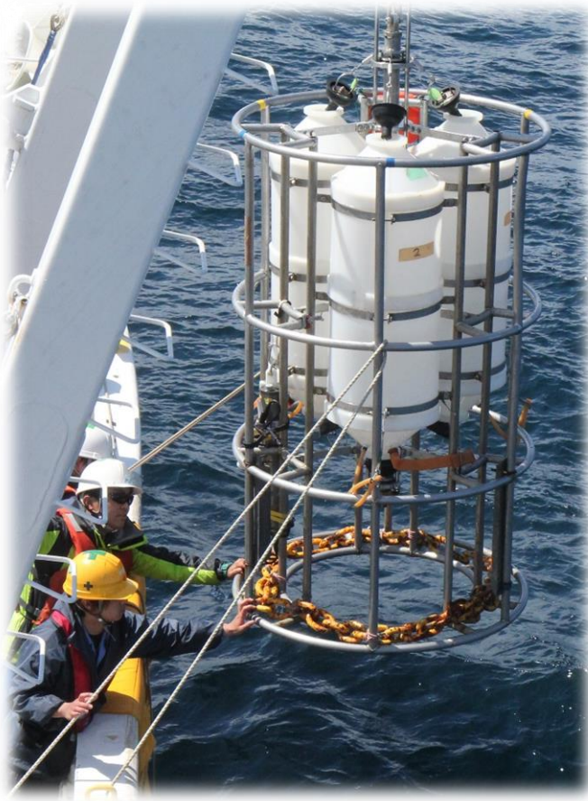
バンドーン式大型採水器による採水作業（写真は容量約120リットル×3連）（令和元年度の作業例）
