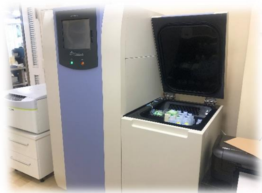
トリチウム分析でトリチウムから発せられる極めて低いエネルギーのベータ線を測定するための液体シンチレーションカウンタの一例
