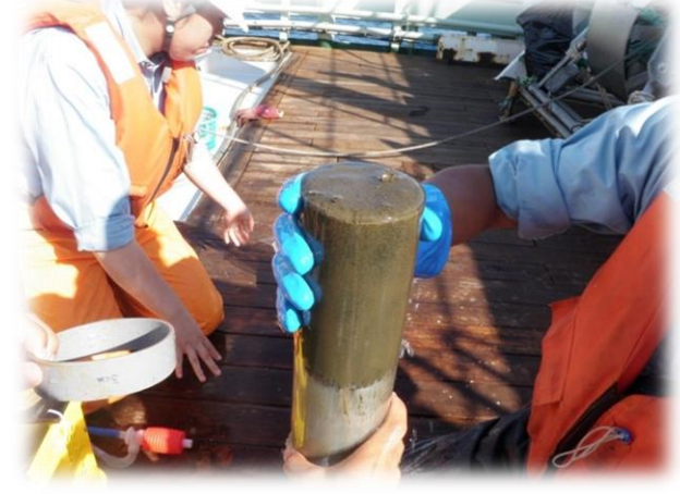
海底土試料の採取作業（コア試料として採取した表層3cmの海底土をスライスして分取しているところ）（令和元年度の作業例）
