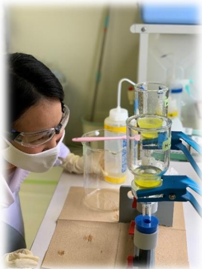
海水試料に含まれる放射性セシウムの放射化学分析の様子（写真はリンモリブデン酸アンモニウムの粉末をろ過しているところ）
