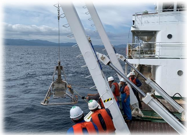
採泥器による採泥作業（写真は主に表層海底土を採取するためのスパード型採泥器）
