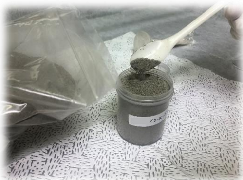
前処理を経た海底土試料を容器に詰めてガンマ線測定に供するための測定用試料を調製しているところ
