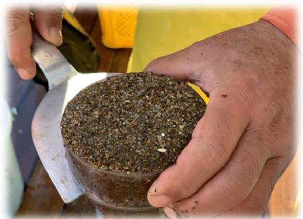
海底土試料の採取作業（表層3cmの海底土をスライスしているところ）
