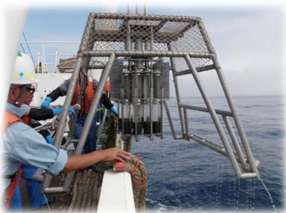
採泥器による採泥作業（写真は主にコア試料を採取するための8本掛けマルチプルコアサンブラ）
