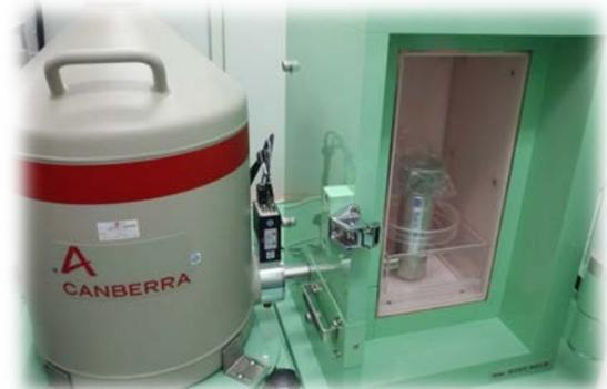
ガンマ線スペクトロメーターに用いる高純度ゲルマニウム半導体検出器（一例）（右の緑部分は鉛の遮蔽で、扉を開けたところ）
