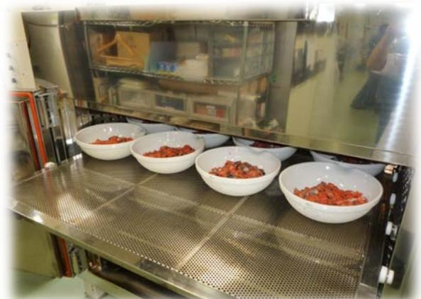
試料の前処理（乾燥器による乾燥後に電気炉で灰化）
