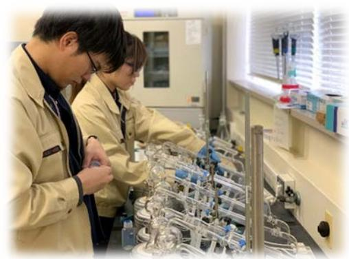
トリチウム分析で電解濃縮を行った後、さらに蒸留・精製を行うための準備をしているところ
