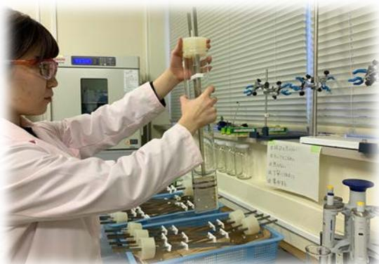
トリチウム分析で電解濃縮を行うための電解セルに電極をセットしているところ
