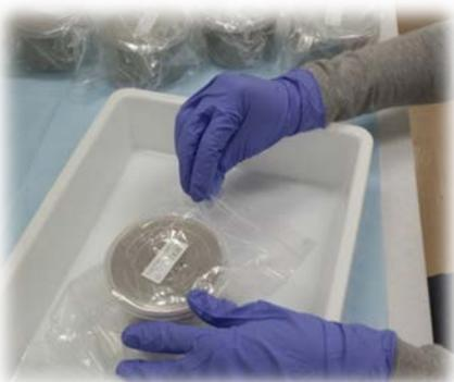
海底土試料を容器に詰めてガンマ線測定に供するための測定用試料を調製しているところ
