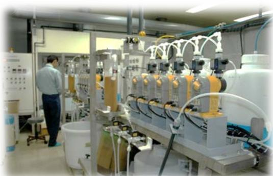
ストロンチウム-90分析のための陽イオン交換樹脂を用いた海水試料自動予備濃縮装置（一例）
