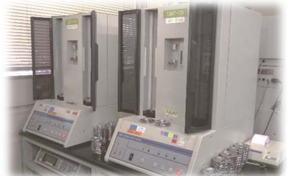
ストロンチウム-90を定量する際に用いる低バックグラウンドガスフローβカウンタ（一例）
