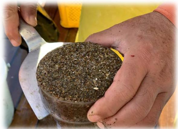
海底土試料の採取作業（表層3cmの海底土をスライスしているところ）
