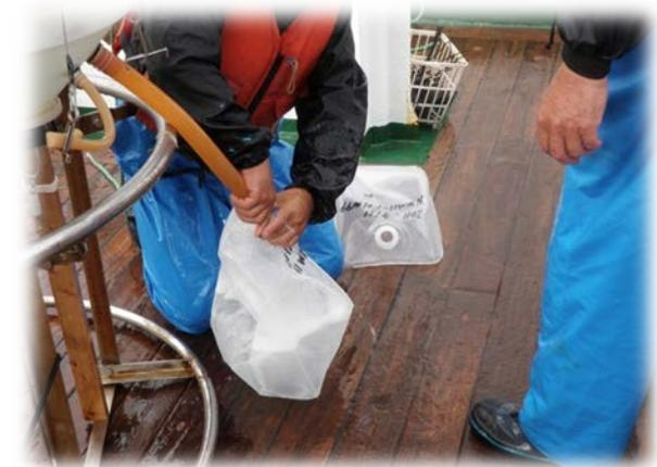
海水試料の採取作業（バンドン式大型採水器から20リットル容器に分取している様子）
