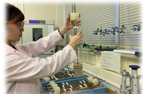
トリチウム分析で電解濃縮を行うための電解セルに電極をセットしているところ
