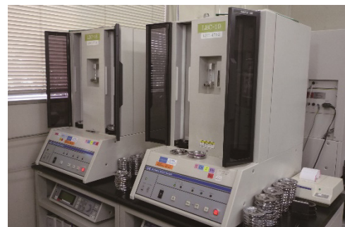
ストロンチウム-90を測定するた めの低バックグラウンドガスフローカウンタ
