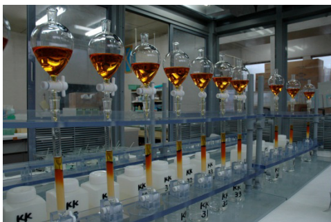
プルトニウム-239+240分析のための 陰イオン交換樹脂カラム
