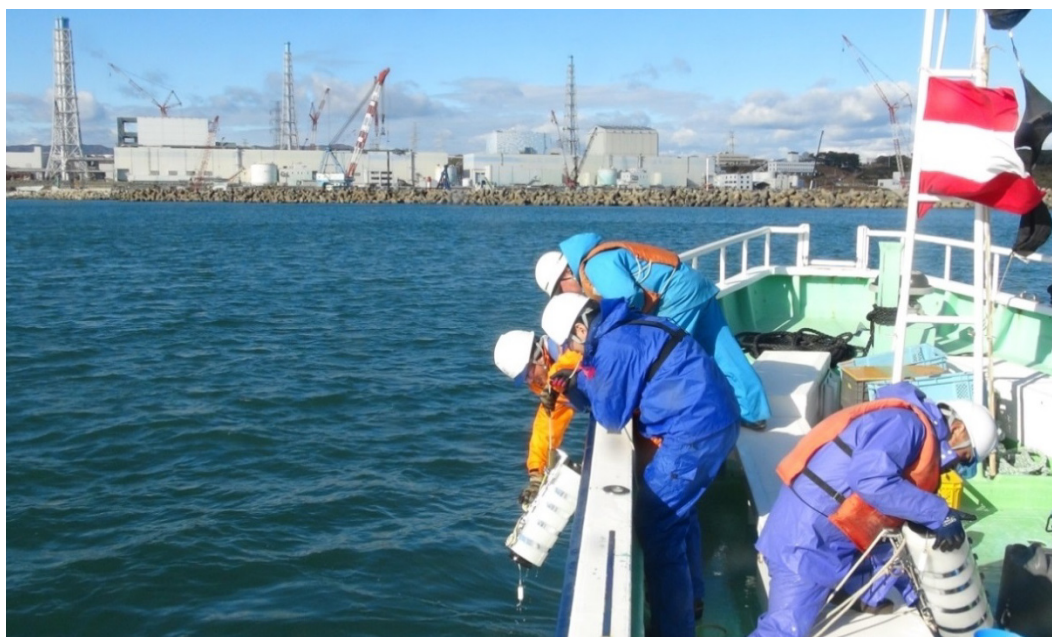
バンドン型採水器を用いて表層水を採取。作業船奥に事故後の東京電力株式会社福島第一原子力発電所1～4号機を望む。
