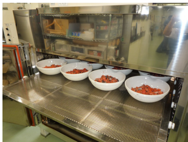
試料の前処理（乾燥器による乾燥後に電気炉で灰化）
