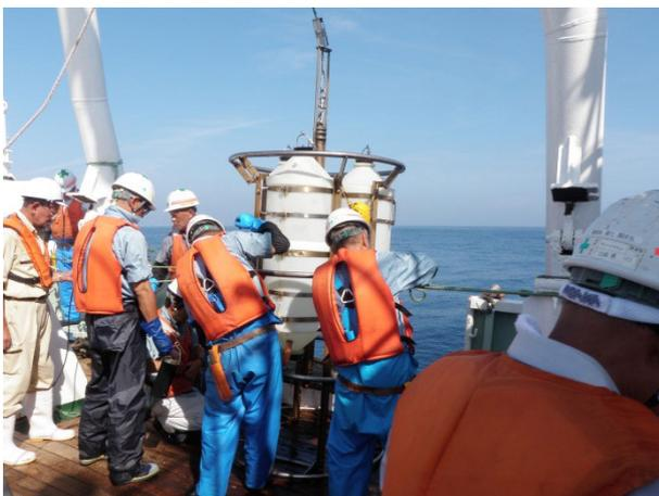
大型採水器による採水作業
