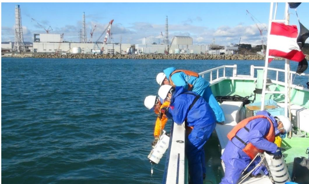
バンドン型採水器を用いて表層水を採取。作業船奥に事故後の福島第一原子力発電所1～4号機を望む。
