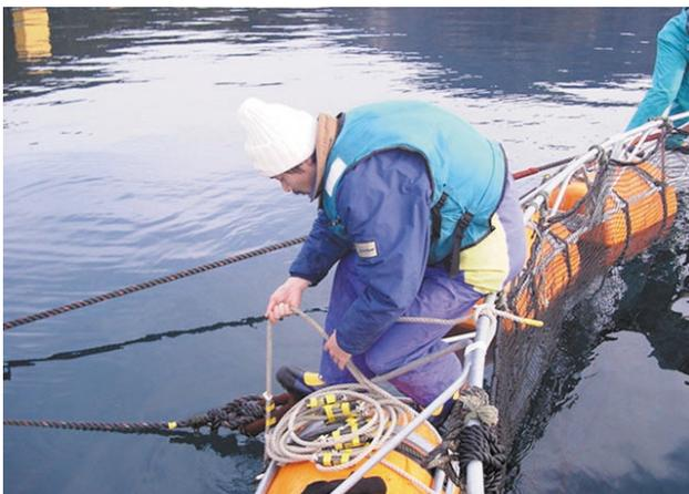
写真5 試験生け簀に設置した水温計
