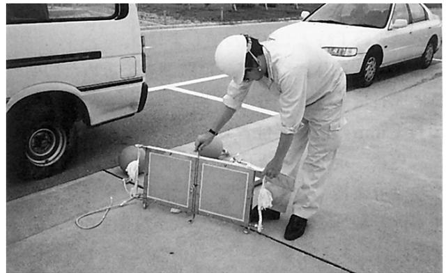
写真1 調査に用いた付着基盤
