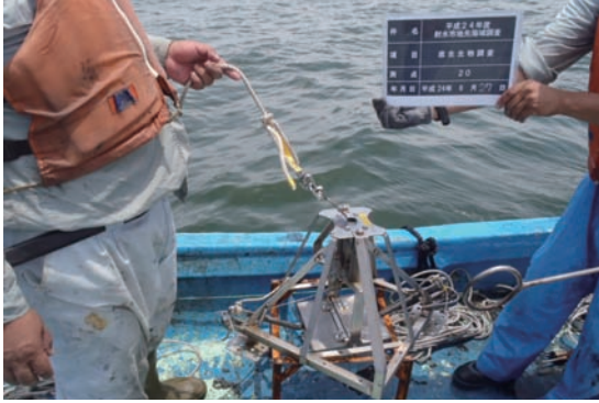
図4 底生生物調査(スミス・マッキンタイヤー型採泥器)
