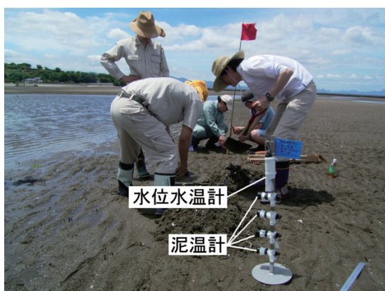
第5図 泥温計の埋設の様子
