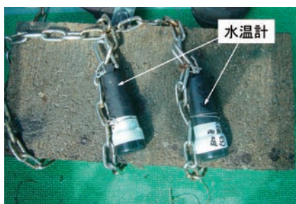
第2図 コンクリートブロックに付けた水温計
