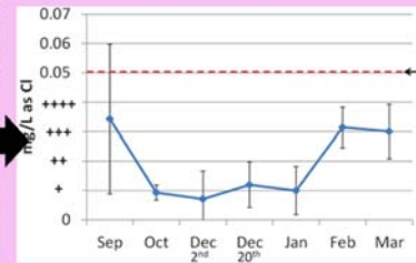
発電所停止中に塩素試薬が発色した例
