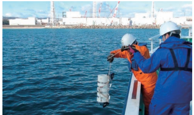
第2図 福島第一原子力発電所を望む海域で海水採取する状況
