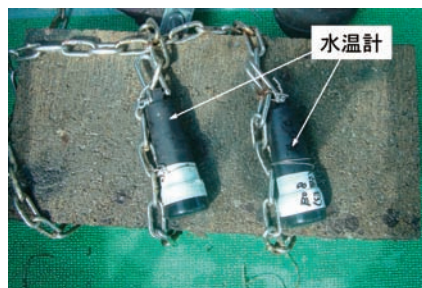
第2図 コンクリートブロックに付けた水温計
