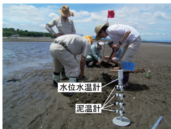
第5図 泥温計の埋設の様子
